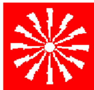
PULSANTE DI ALLARME ANTINCENDIO
