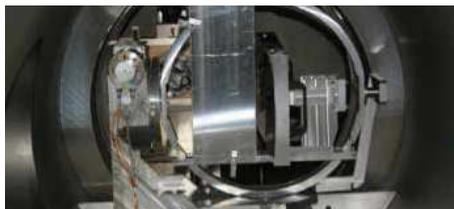
Prototipo di ottica attiva per raggi X realizzata con due specchi in vetro sottile (parabola-iperbole in configurazione Wolter I) sui quali sono applicati dei piezo ceramici tangenziali di diverse dimensioni e disposizioni geometriche. Nella stessa figura è mostrato lo stesso prototipo installato su una montatura alta-azimutale dentro la beam-line da vuoto prima dei test in raggi X.
