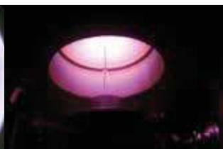
Stazione di Plasma-Enhanced Chemical Vapour Deposition realizzata presso il laboratorio dell'INAF-OAPA (sinistra). A destra sono mostrate due immagini della camera di processo in cui è stato innescato plasma, rispettivamente, di Argon e di Metano.
